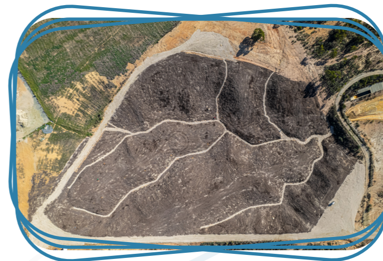
Proyecto piloto de Lousal después de la aplicación del método GeoFluv™. Projeto piloto do Lousal após a aplicação do método GeoFluv™. Lousal pilot project after the application of the GeoFluv™ method.
